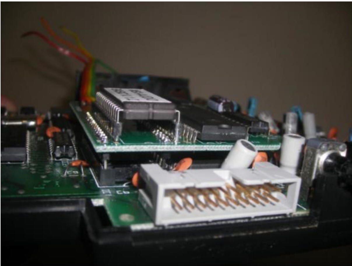
Onderaanzicht van de geïnstalleerde uitbreidingsprint.
