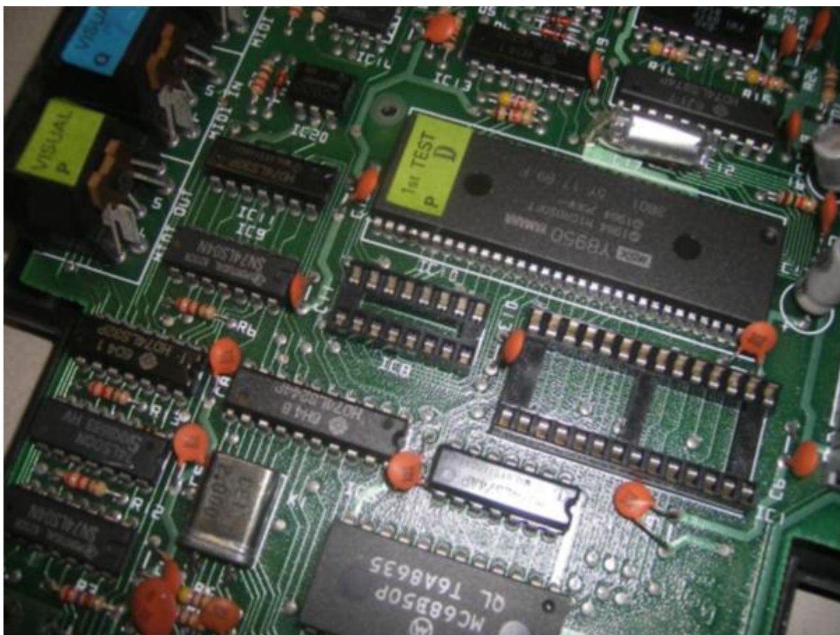
IC1 is verwijderd en IC8 is vervangen door een IC-voet.
