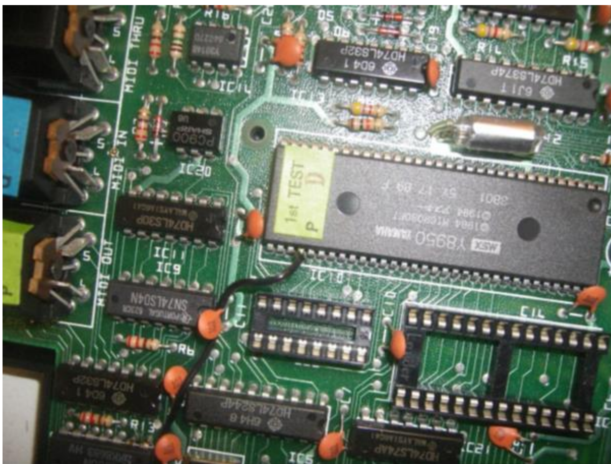
Pin 35 van IC10 en pin 9 van IC2 zijn verbonden met de zwarte draad.
