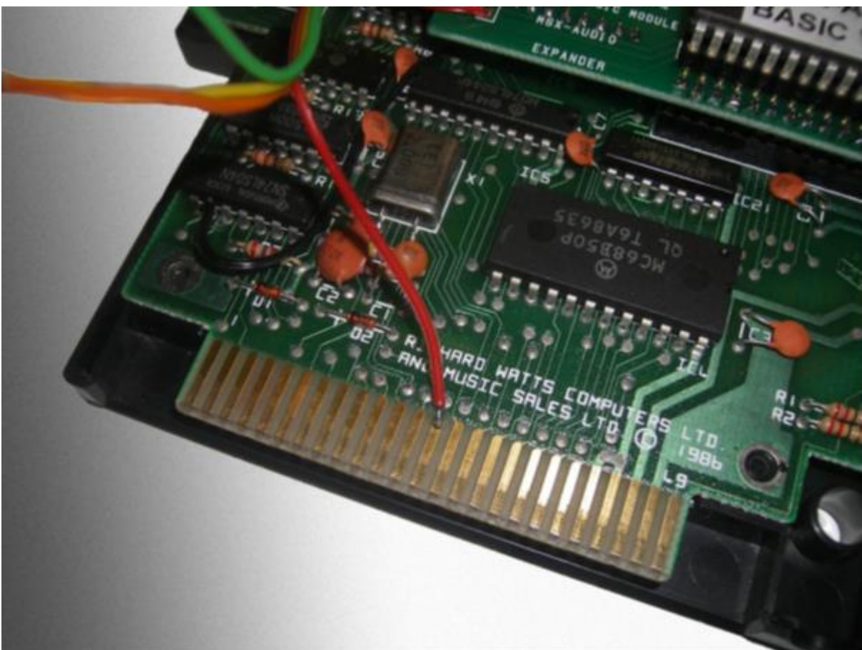
De rode draad is verbonden met pin 25 van de slotconnector.
